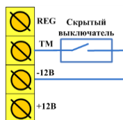
Рисунок 6.7 — Схема подключения скрытого выключателя или кнопки
